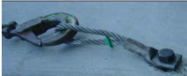
4 prises extérieures situées à 60 cm du dessus du conteneur servent à la fixation des élingues sur le béton
